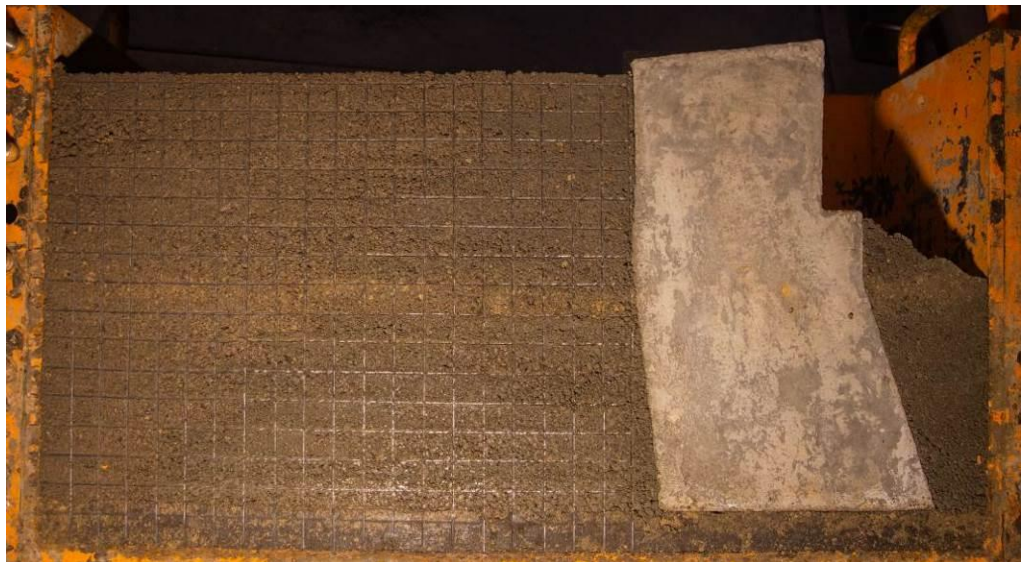
Рис. 3.11 Деформовані моделі стояна мосту та насипу із підсиленням габіонними коробами (а), ґрунтоцементними палями (б) і сортованим ґрунтом (в)
