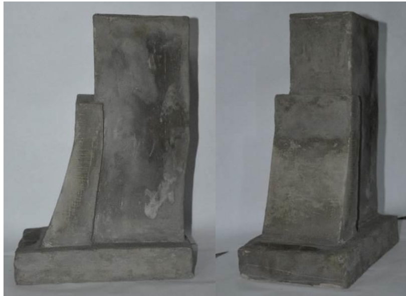
Рис. 3.3 Модель стояна мосту, виконана із цементу
